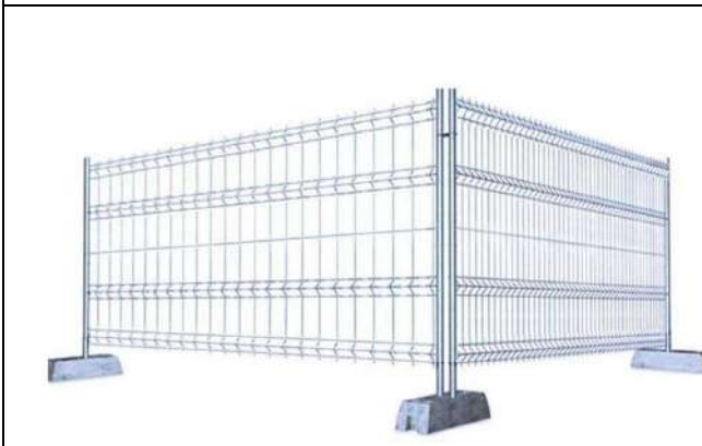
Tanca mòbil, de 2 m d'alçada, d'acer galvanitzat, amb malla electrosoldada de 90x150 mm i de 4,5 i 3,5 mm de D, marc de 3,5x2 m de tub de 40 mm de D, fixat a peus prefabricats de formigó
